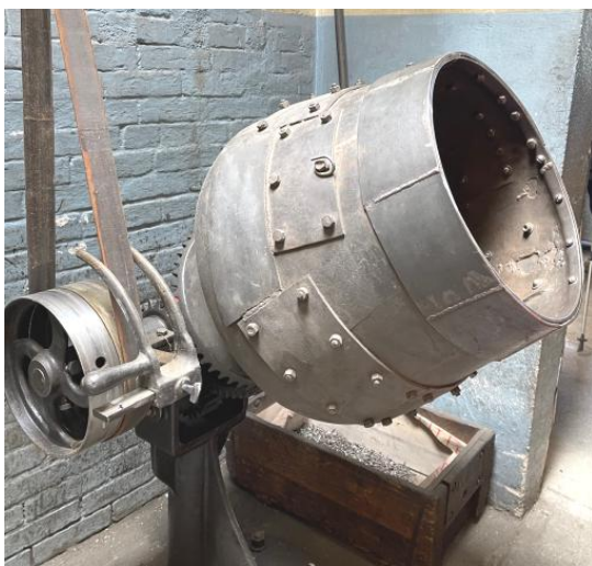
Kein Betonmischer, sondern eine Nagel-Waschmaschine
