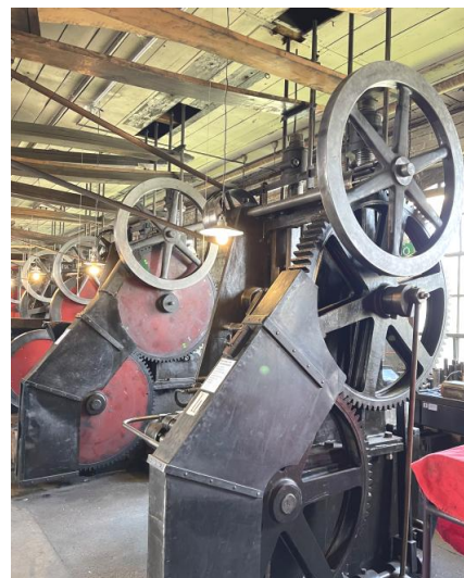
320 verschiedene Nagelarten werden mit diesen uralten und sehr lauten Maschinen gefertigt
