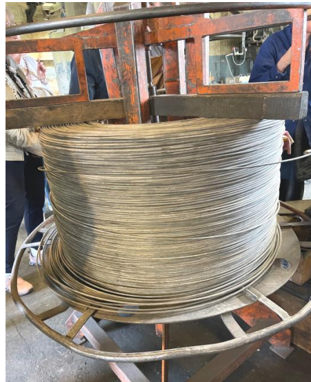
Ab Rolle wird der Draht durch Lochschablonen mit verschiedenem Durchmesser gezogen
