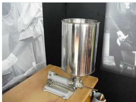
Und unmittelbar daneben eine sogenannte Tubenfüllmaschine.
