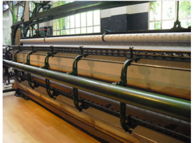
Handstickmaschine, gesteuert von einem Pantographen ab Handzeichnung (Chlüpperlimaschine)
