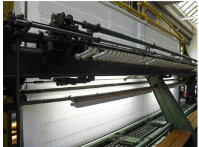
Hier eine lochkartengesteuerte Stickmaschine.
