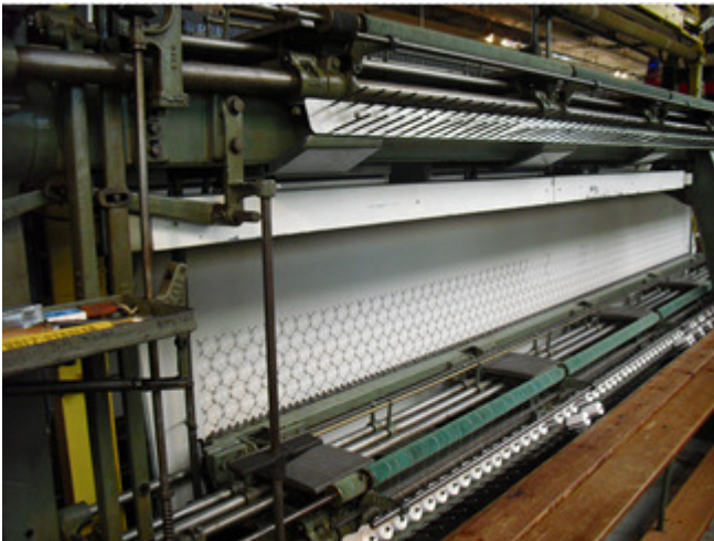
Schiffchenstickmaschine, erstes Modell von Saurer 1878. Bis 1910 wurden 6150 Stück hergestellt.
